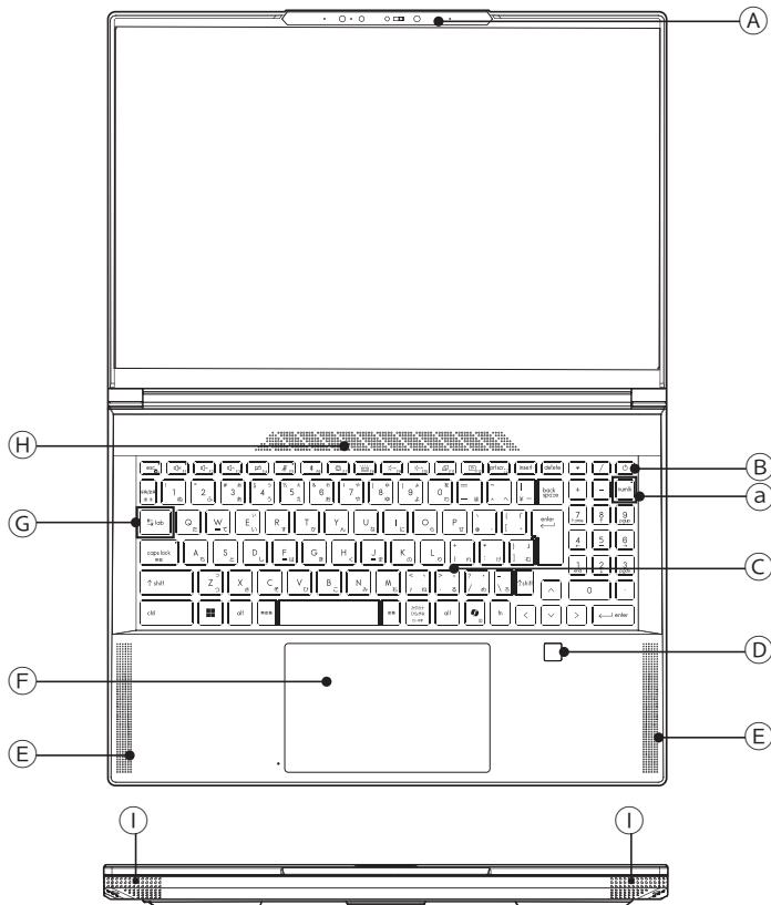
Ⓐ ウェブカメラ/赤外線カメラモジュール/内蔵マイク/カメラLED（カメラ オン：点灯）
